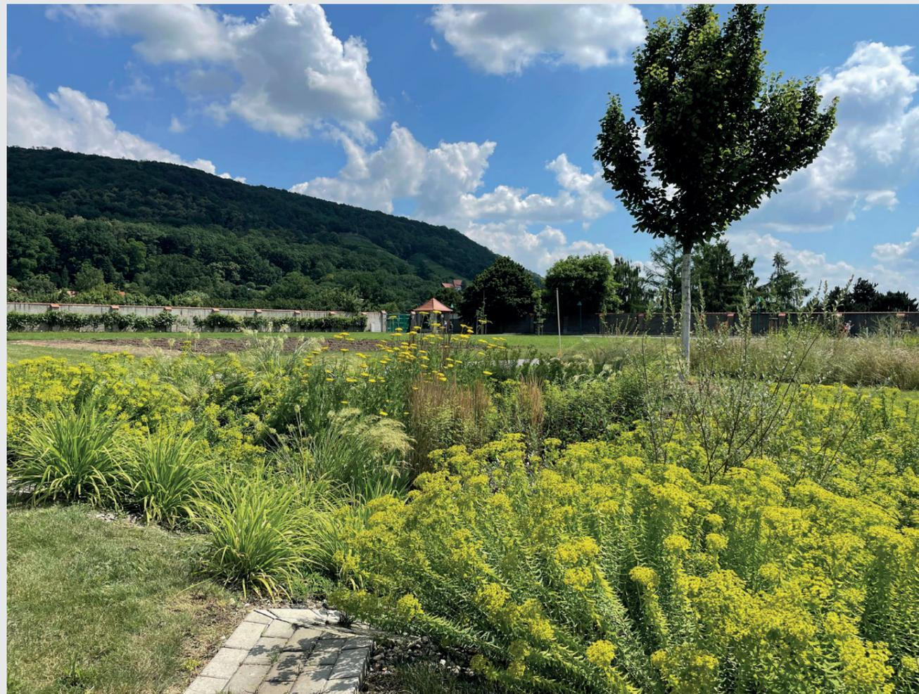
Bild 6 Mit Stauden bepflanzte Versickerungsmulde im Versuchsfeld des LfULG
